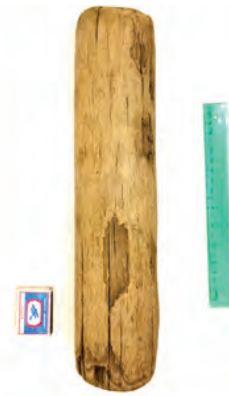
Самодельное деревянное приспособление — чушка — для придания формы валенку. Тамбовская обл., пгт Мучкап. 2023 г. Фото из личного архива Т. В. и Я. В. Махрачевых
