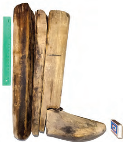
Самодельная деревянная разборная колодка, используемая при изготовлении валяной обуви. Общий вид. Тамбовская обл., пгт Мучкап. 2023 г. Фото из личного архива Т. В. и Я. В. Махрачевых
