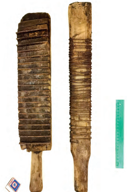
Рубели, используемые при изготовлении валяной обуви. Тамбовская обл., пгт Мучкап. 2023 г. Фото из личного архива Т. В. и Я. В. Махрачевых
