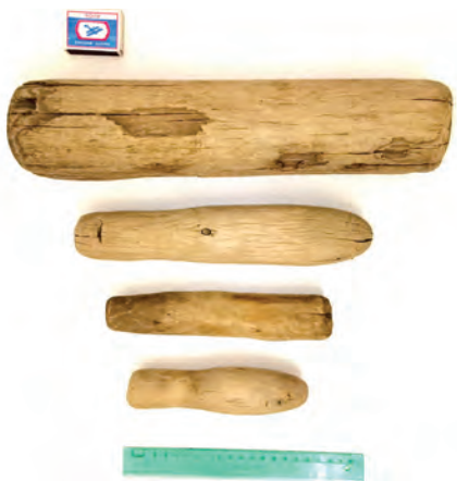
Самодельное деревянное приспособление — чушка — для придания формы валенку, а также приспособления, используемые для валяния обуви больших размеров. Тамбовская обл., пгт Мучкап. 2023 г. Фото из личного архива Т. В. и Я. В. Махрачевых
