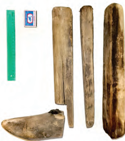
Части деревянной разборной колодки: задник, клин (вариант: середник), передник, сама колодка. Тамбовская обл., пгт Мучкап. 2023 г. Фото из личного архива Т. В. и Я. В. Махрачевых
