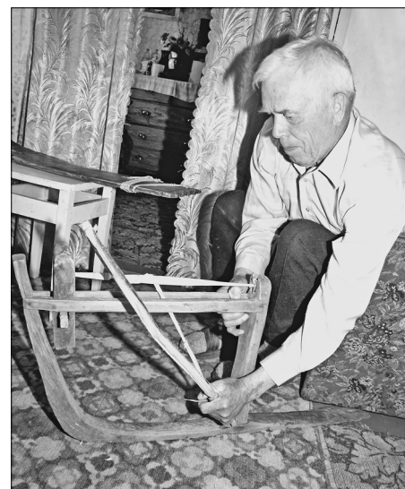
В.М. Трапезников, 1931 г.р., показывает, как вытачивают веретена на токарном станке. С. Лепша (Ступино) Няндомского р-на Архангельской обл. 2007 г. Фото А.Б. Мороза
